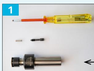
Estrarre la vite dal codolo cilindrico con il cacciavite corrispondente. Soffiare con aria compressa secca. Riempire con 10 gocce di olio.
