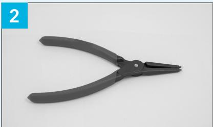
Rimuovere l'anello di tenuta con delle pinze.
