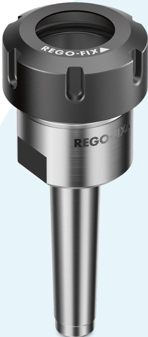
**Applicazioni** I portapinze con attacco cono Morse (DIN 228-A) sono filettati internamente per l'inserimento del tenone. Dunque possono essere utilizzati su fresatrici, alesatrici e torni. I tenoni filettati (ATL) possono essere ordinati come optional.
