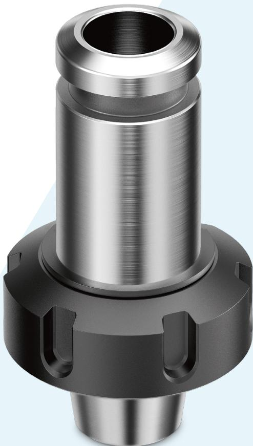
**Cosa è?** L'adattatore swissQuick ER-PG è un "mini-mandrino" corto con un profilo integrale tipo ER sul retro ed una sede per pinze powRgrip sul fronte. Questo design unico consente un cambio utensile rapido con un serraggio di tipo ER, pur godendo dei vantaggi del sistema powRgrip.
