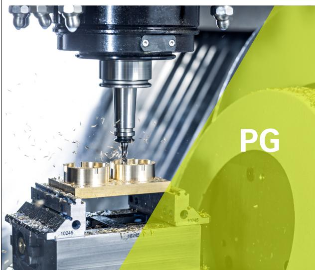
**La logica evoluzione** Una ghiera senza scanalature per minori vibrazioni ed un runout dell'intero sistema  $\leq 3 \mu\text{m}$  a  $3 \times D$  offrono una precisione incomparabile per un sistema a pinza. Il suo inventore reinventa la pinza ER.
