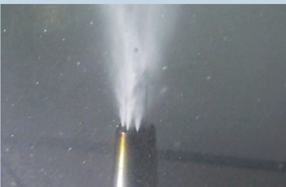
Cool Flash – refroidissement efficace sur les arrêtes de coupe Cool Flash – raffreddamento effettivo fino al tagliente
